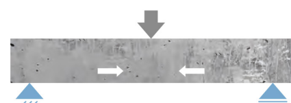
En béton post-contraint, la traction décomprime le béton initialement comprimé par les câbles
