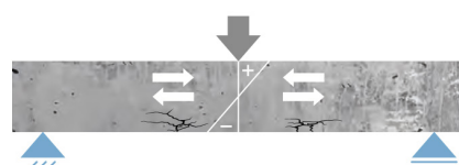
La traction dans le béton le fissure
