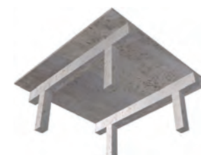
Dalles pleines sur poutres à retombée
