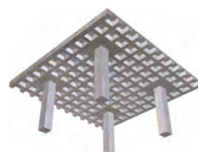
Dalles gauffrées avec panneaux pleins
