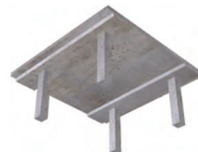
Planchers-dalles à sur-épaissements
