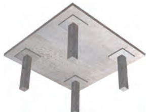
Planchers-dalles avec sur-épaissements aux appuis
